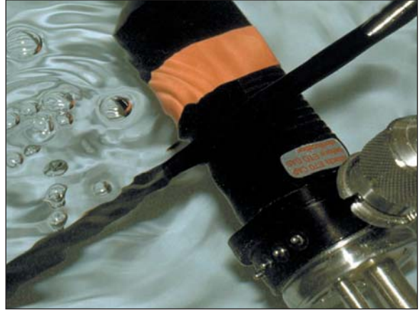
Resim 6. Bronkoskopun "pozitif kaçak testi".
